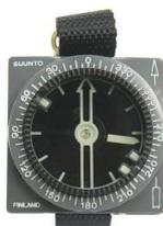
Sur une **boussole**, c'est l'aiguille qui bouge sur une rosace fixe.
